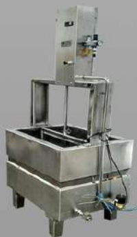
Tanque de Encolhimento Com Controlador de Temperatura
