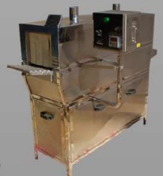
Túnel de Encolhimento
